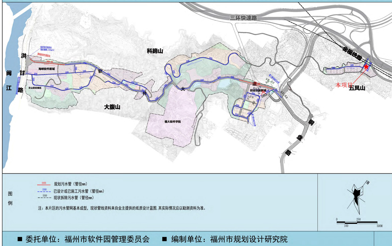
附图 14 园区污水管网图
