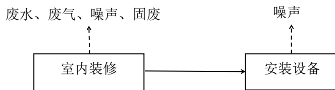
图 2.7-1 施工期工艺及产污节点图
